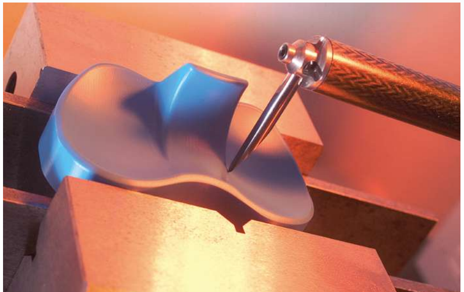
↑ Contrôle d'une prothèse d'essai de genou au moyen d'un contouroscopie (mesureur de profil)
