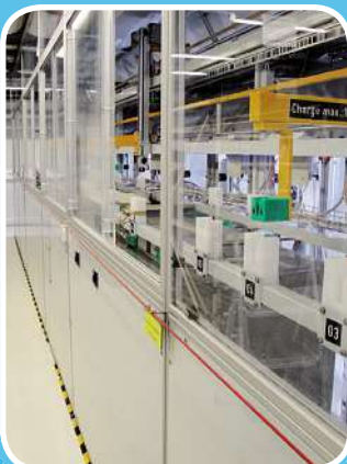
Machine entièrement fermée installée en salle grise
