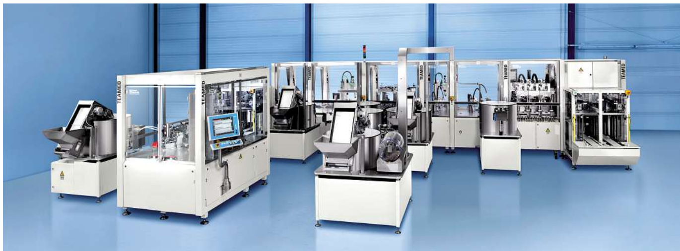
Illustration 1 : Équipement d'assemblage et de contrôle de stylos injecteurs conçu par Teamtechnik pour la société Haselmeier
