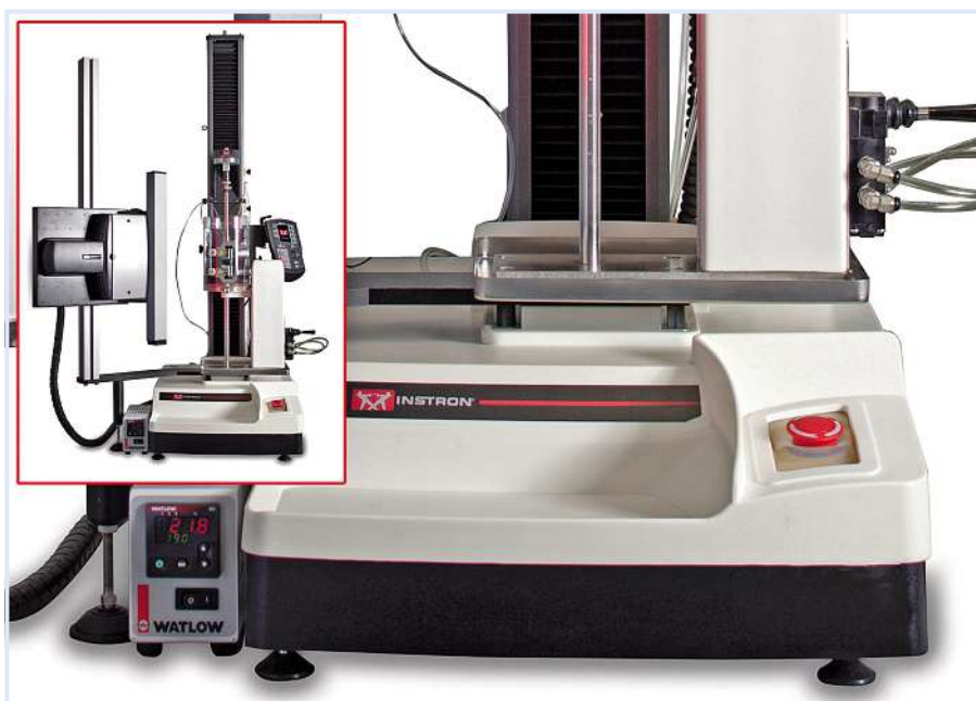
Illustration 1 : La protection BioCoat empêche les fluides des bains de pénétrer à l'intérieur de la machine, par suite de fuites ou d'éclaboussures, et d'endommager l'électronique du système
