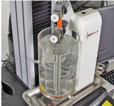
Illustration 2 : Utilisées avec le bain BioPuls et les mâchoires pneumatiques submersibles du même nom, les machines de traction mono-colonne série 5940 sont idéales pour tester les dispositifs médicaux et les biomatériaux
