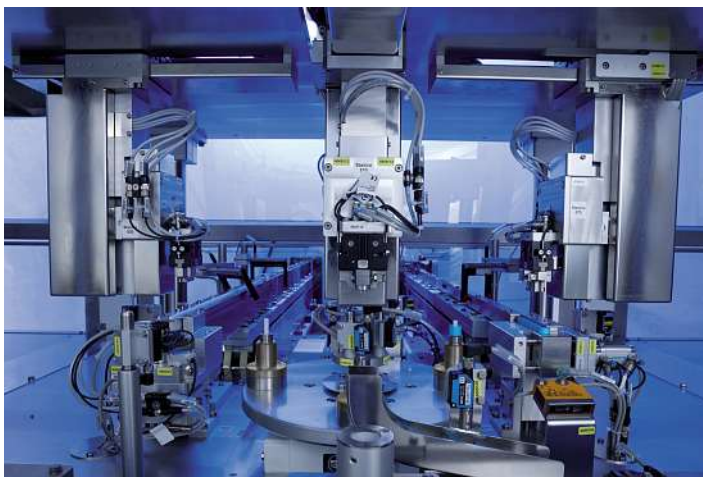
Illustration 2 : Pré-assemblage du bouton de déclenchement du stylo injecteur
