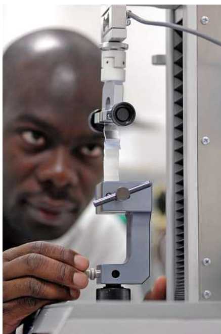
Illustration 1 : Essai de traction pour déterminer la résistance de scellage d'un conditionnement
