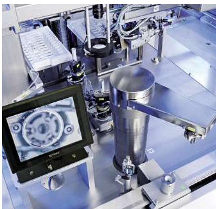
Illustration 3 : Contrôle et mise en place du boîtier du stylo injecteur
