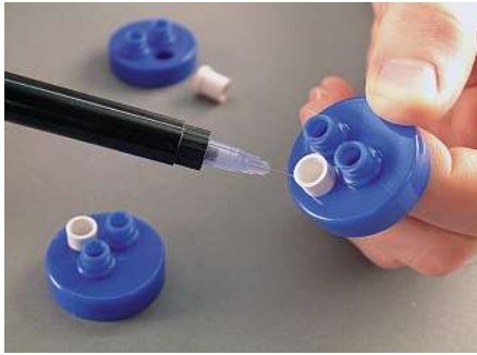
Illustr. 2 : Les colles qui durcissent aux UV en quelques dizaines de secondes se prêtent bien à l'assemblage des DM à usage unique, souvent produits en grands volumes.
