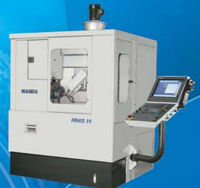
Centre multifonction de super précision REALMECA RMS Fraisage et tournage de pièces complexes de petites et moyennes dimensions.
