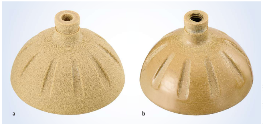
Illustration 1 : Implant, avant (a) et après (b) le traitement MMP
