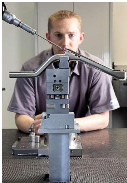
Illustration : Contrôle par palpage 3D d'un composant d'instrument médical
