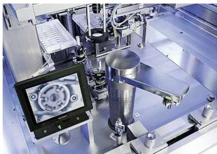
Illustration 1 : Station d'insertion et de contrôle du corps du stylo.
