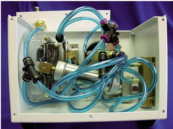
**Illustration 3 :** La vanne de distribution Clippard R-331 est placée derrière les tuyaux du respirateur Magellan
