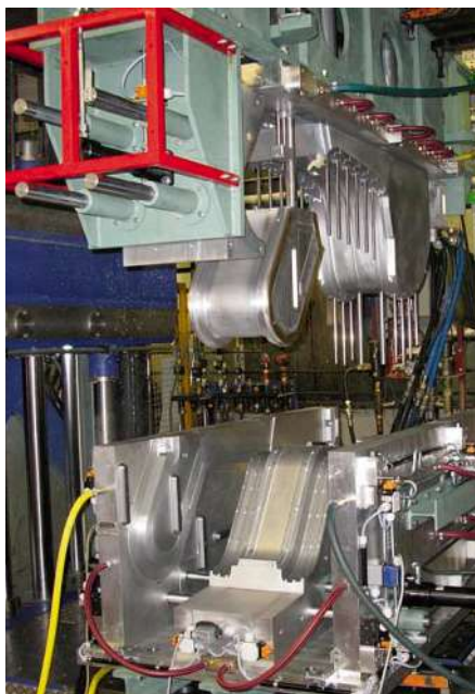
Illustration 2 : Exemple de moule conçu par le bureau d'étude de Thieme pour former, en deux pièces seulement, le piètement d'un équipement d'imagerie de GE Healthcare.
