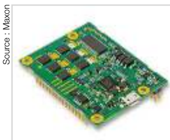
Le module EPOS4 occupe peu d'espace : 59,5x46,0x14,1 mm.
