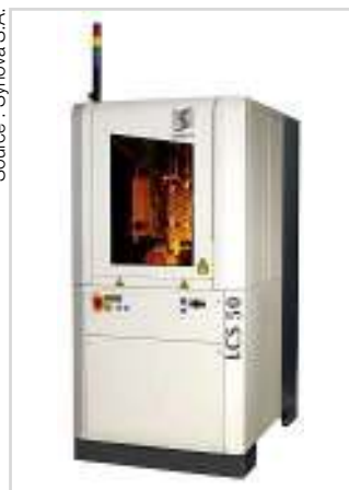
La technologie Laser-MicroJet est une technique de découpe froide, sans altération thermique.
