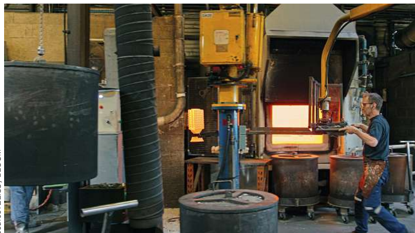
Réalisation de prothèses de genou par fonderie à la cire perdue sur le site de Nowak.
