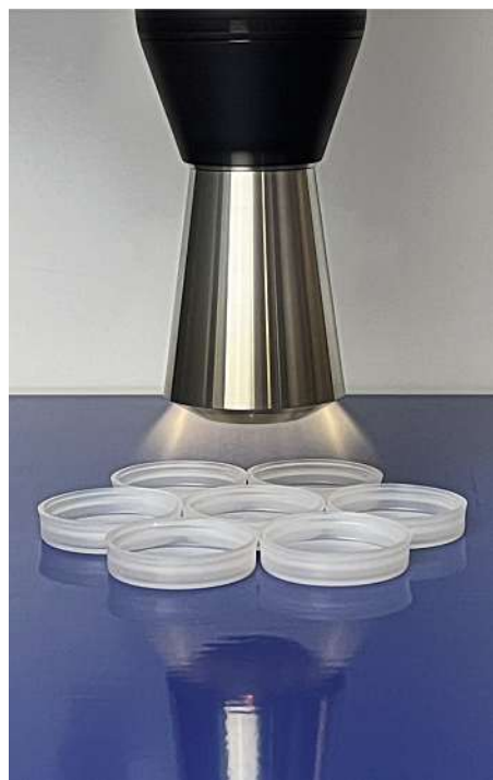
Buse rotative pour le traitement plasma de bouchons
