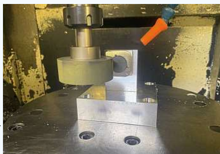
Polissage avec meule de la nouvelle céramique sur centre d'UGV 5 axes
