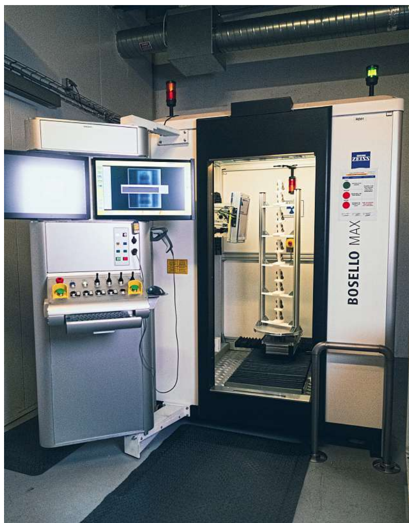
L'équipement ZEISS Bosello Max est une solution de radiographie 2D personnalisable. Ses algorithmes de traitement d'images exclusifs permettent la détection et l'analyse complète de diverses pièces de fonderie.
