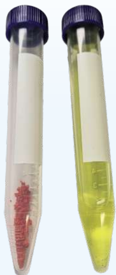
Préparation de la solution de ferricyanure de potassium et d'acide nitrique
