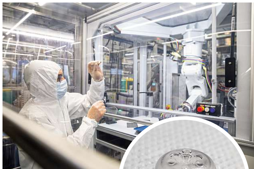
Cellule de production robotisée en salle blanche ISO 7
