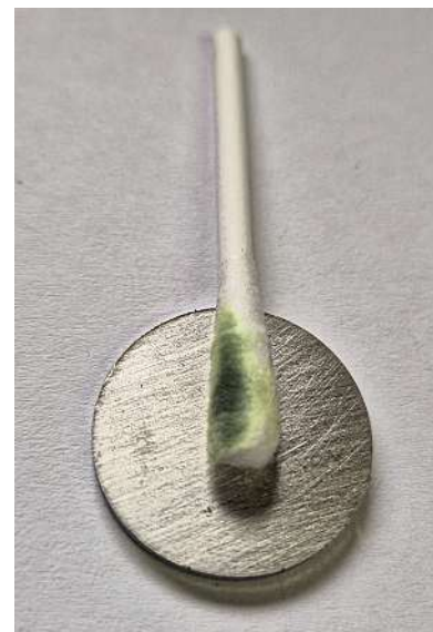
En l'absence de fer libre, la solution reste jaune (à gauche). La présence de fer libre la fait virer au bleu (à droite) en quelques minutes, indiquant une passivation insuffisante.
