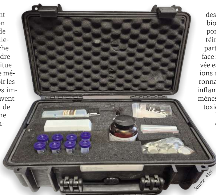
Kit de test au ferroxyle
