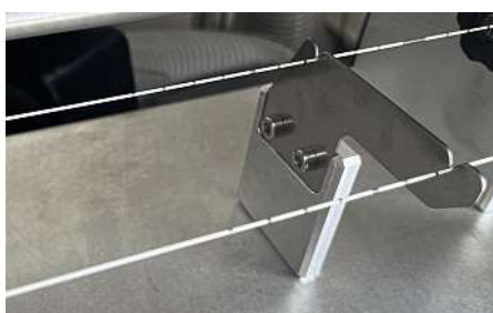
Graduation par marquage laser d'une fibre de 950 \mu\text{m} de diamètre
