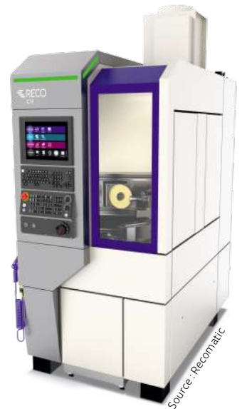
La RECO CT5 est destinée par exemple à la rectification des prothèses de hanche.
