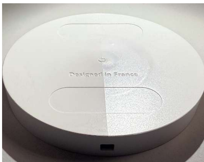
Pièce injectée dont la partie gauche a bénéficié d'une texturation de l'outillage.
