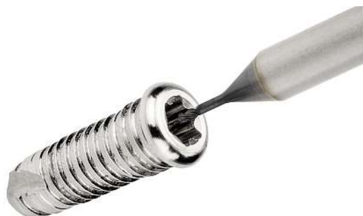
Fraise VQXL utilisée pour la réalisation d'une empreinte Torx
