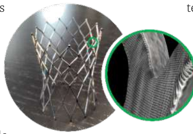
Microstructures d'un stent obtenues par DLIP Source : SurFunction
