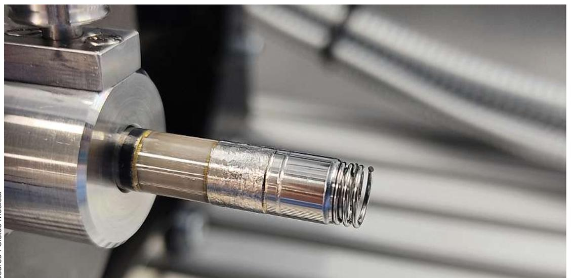
Soudure laser d'un boîtier titane d'implant cardiovasculaire
