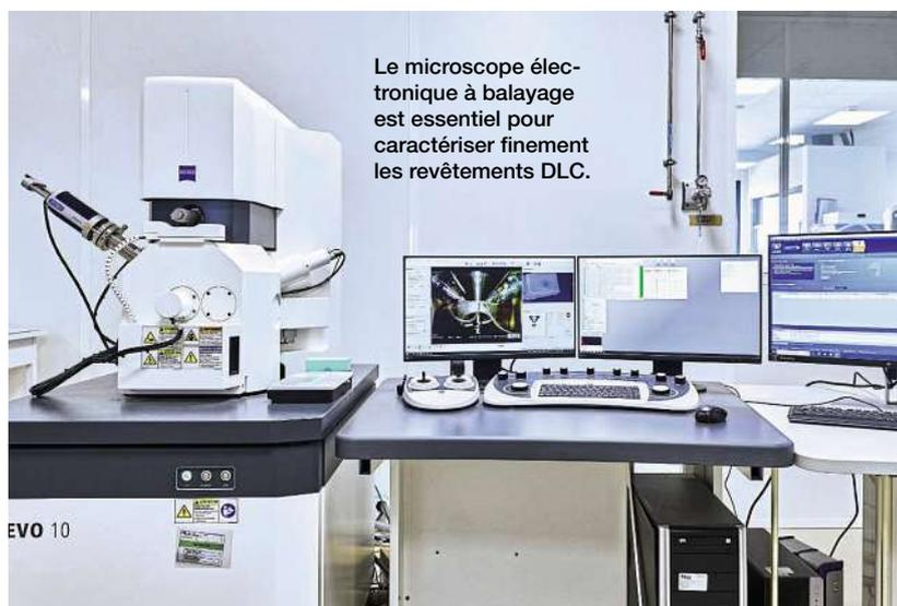
Le microscope électronique à balayage est essentiel pour caractériser finement les revêtements DLC.
