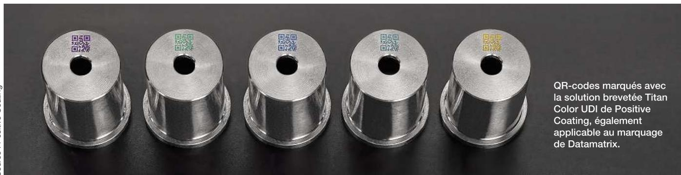
QR-codes marqués avec la solution brevetée Titan Color UDI de Positive Coating, également applicable au marquage de Datamatrix.
