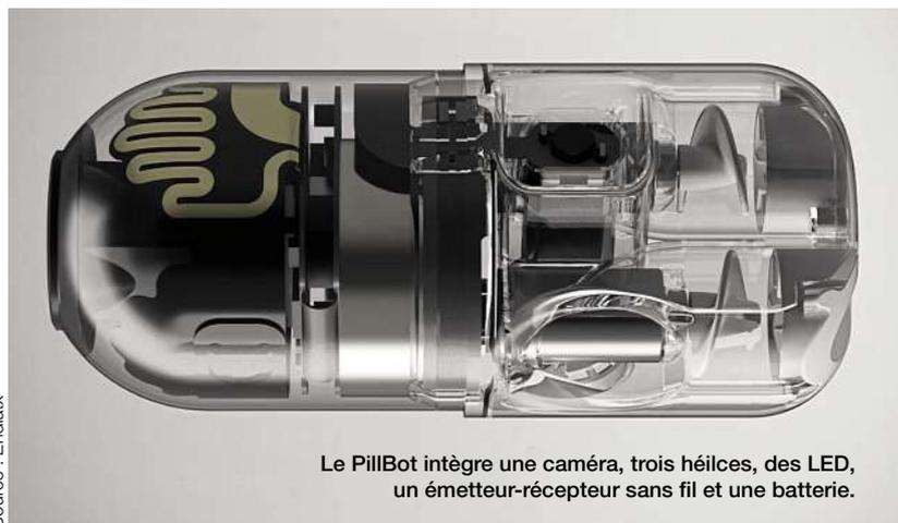
Le PillBot intègre une caméra, trois hélices, des LED, un émetteur-récepteur sans fil et une batterie.
