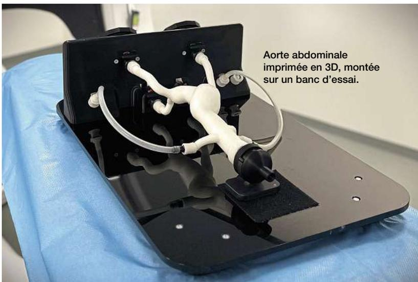
Aorte abdominale imprimée en 3D, montée sur un banc d'essai.
