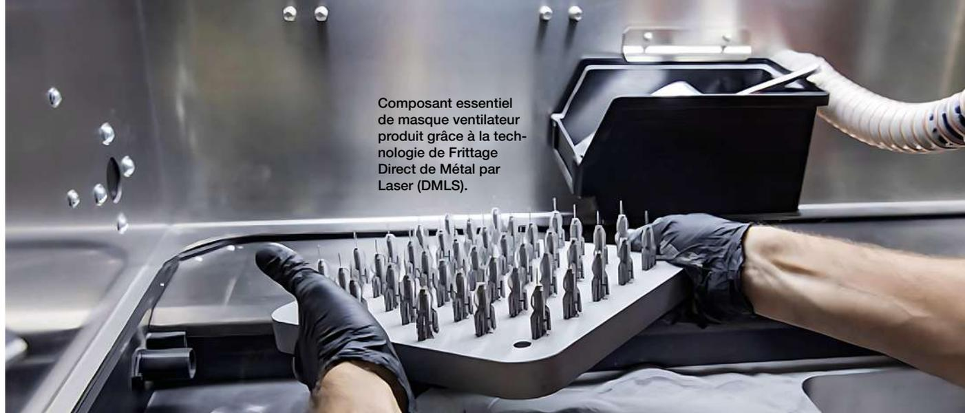
Composant essentiel de masque ventilateur produit grâce à la technologie de Frittage Direct de Métal par Laser (DMLS).
