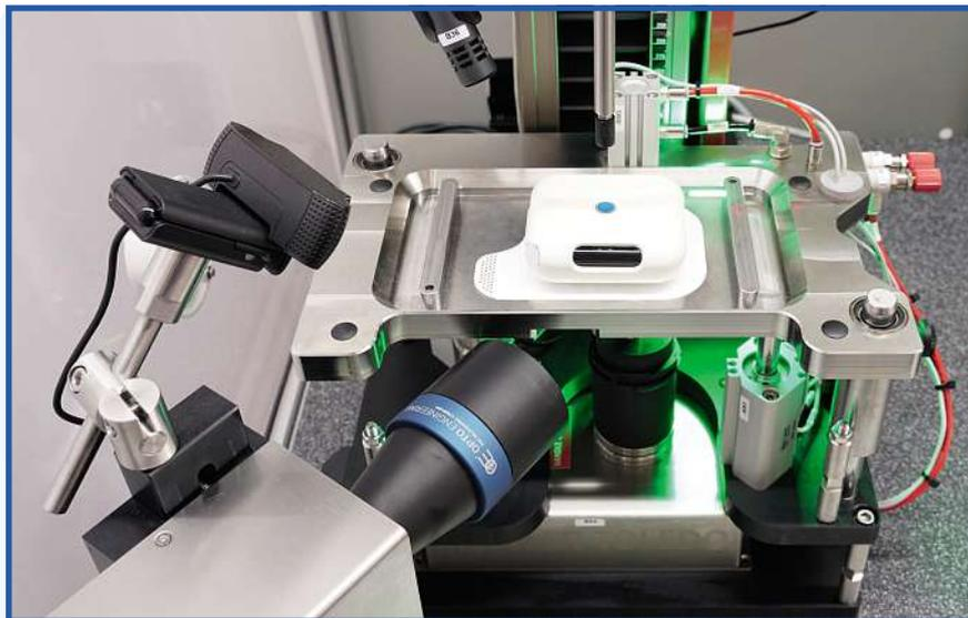
La machine d'essai intègre une caméra ainsi qu'un microphone pour suivre les réactions des auto-injecteurs en matière d'affichage et de signaux sonores.
