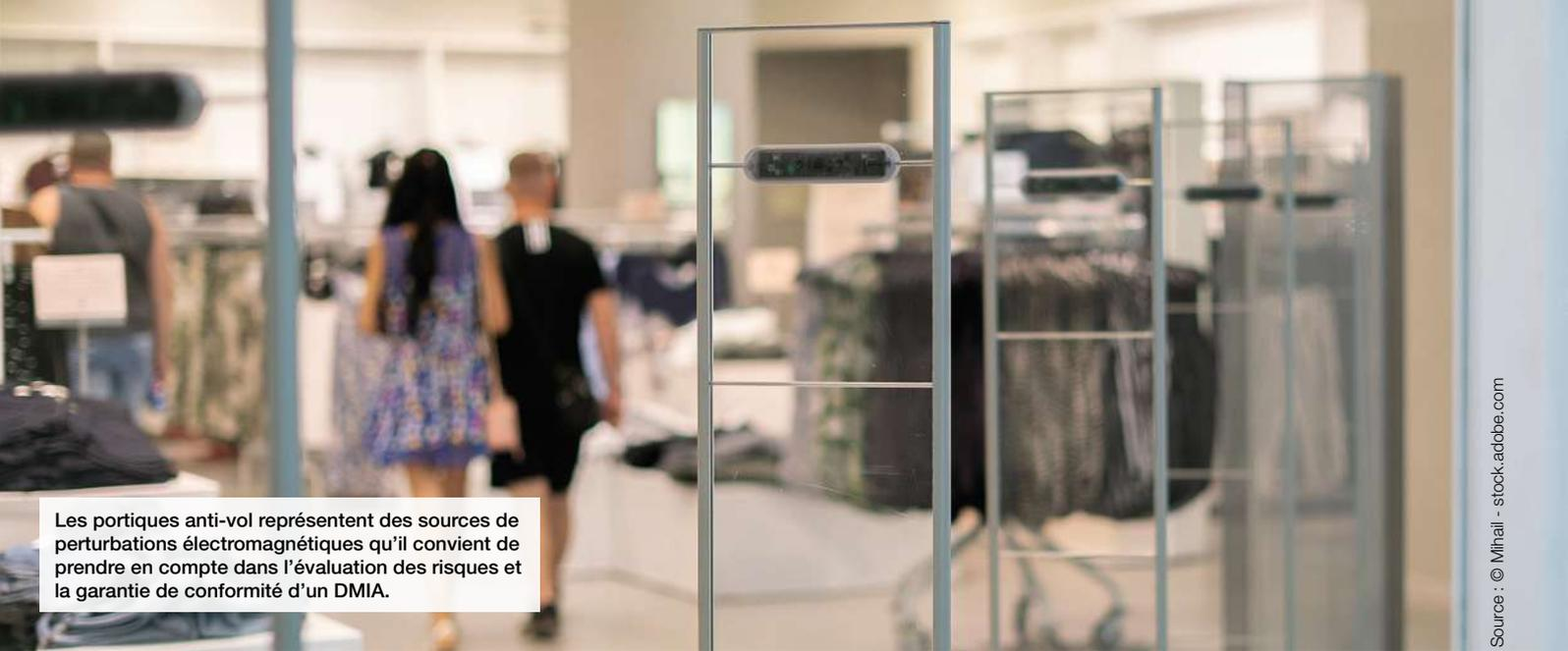
Les portiques anti-vol représentent des sources de perturbations électromagnétiques qu'il convient de prendre en compte dans l'évaluation des risques et la garantie de conformité d'un DMIA.
