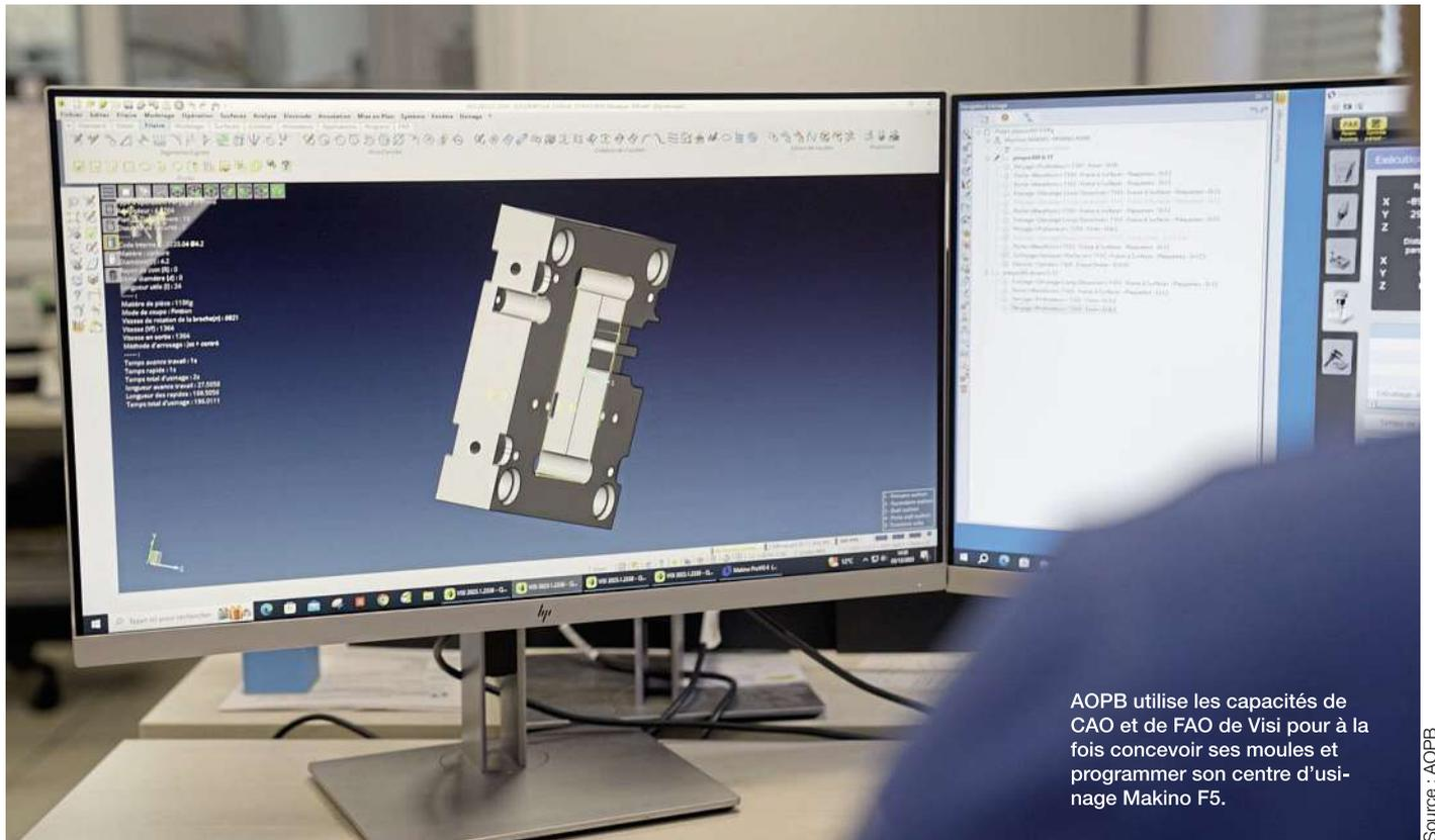
AOPB utilise les capacités de CAO et de FAO de Visi pour à la fois concevoir ses moules et programmer son centre d'usinage Makino F5.
