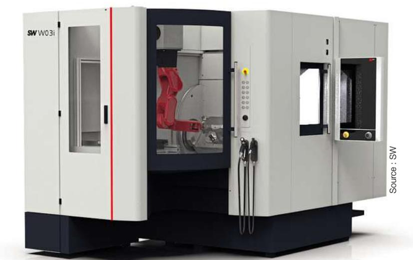
Les machines SW W03 offrent un niveau très élevé de précision et permettent de se conformer à des tolérances de l'ordre du micron.
