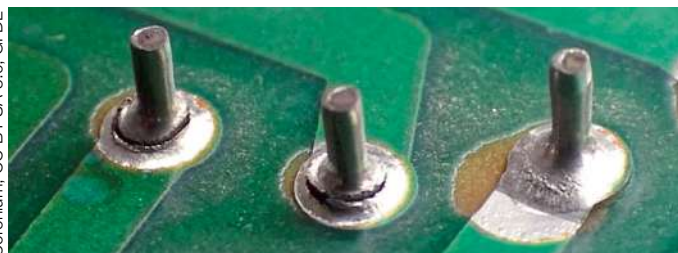
Problèmes de qualité observés sur le brasage de composants électroniques
