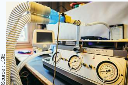
Testeur de ventilateur QA-VT METRON destiné à simuler la respiration d'un patient à l'aide d'un poumon d'essai
