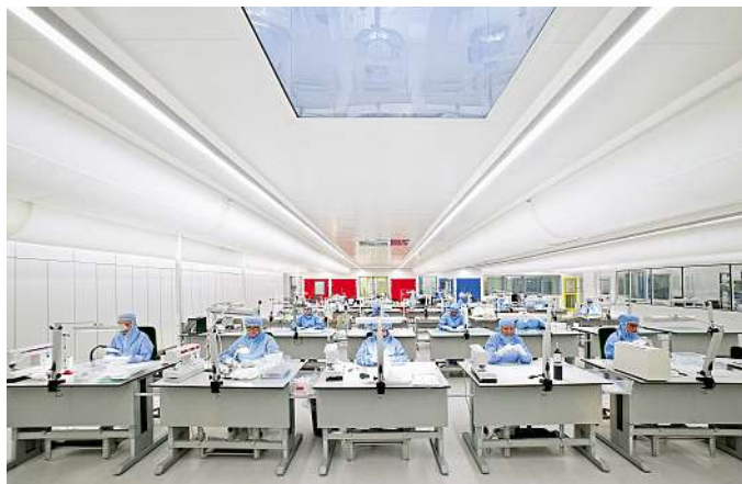
Fabrication d'implants textiles en salle blanche sur le site de Cousin Surgery
