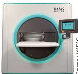
La cinématique innovante de la machine Malta de MAFAC assure un dégraissage sans particules.
