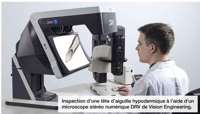
Inspection d'une tête d'aiguille hypodermique à l'aide d'un microscope stéréo numérique DRV de Vision Engineering.
