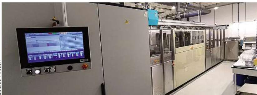
**Nouvelle ligne combinant électropolissage et nettoyage.**
