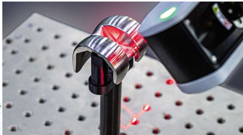
Scanner laser HP-L-10.10 à l'œuvre sur la pièce fémorale d'une prothèse de genou.
