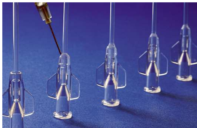
Assemblage de connecteurs à l'aide de la colle Vitralit UV 7030 de Panacol.
