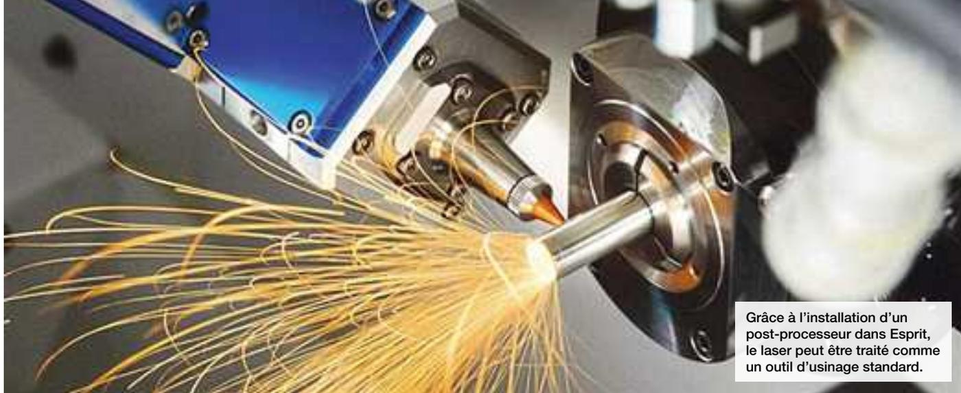
Grâce à l'installation d'un post-processeur dans Esprit, le laser peut être traité comme un outil d'usinage standard.
