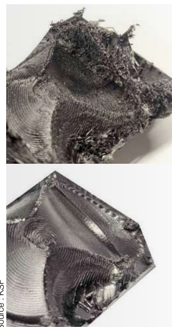
Fig. 2 - Résultats du fraisage à sec (en haut) et avec CO 2 supercritique (en bas) d'un insert de prothèse de genou.
