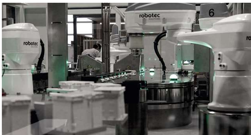
En quelques secondes, 96 pointes de pipettes sont transférées, assemblées, inspectées et emballées.
