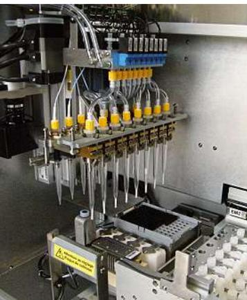
Cet automate est destiné à la préparation automatique du sang pour analyse par spectromètre de masse (identification des bactéries et des levures). Alcym a dû intégrer dans sa conception pas moins de 15 opérations automatiques.
