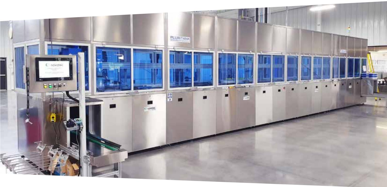
! CleanSonic propose une **large gamme** d'équipements de **nettoyage par ultrasons**, en **milieu lessiviel**, répondant à l'ensemble des besoins de nos clients.
