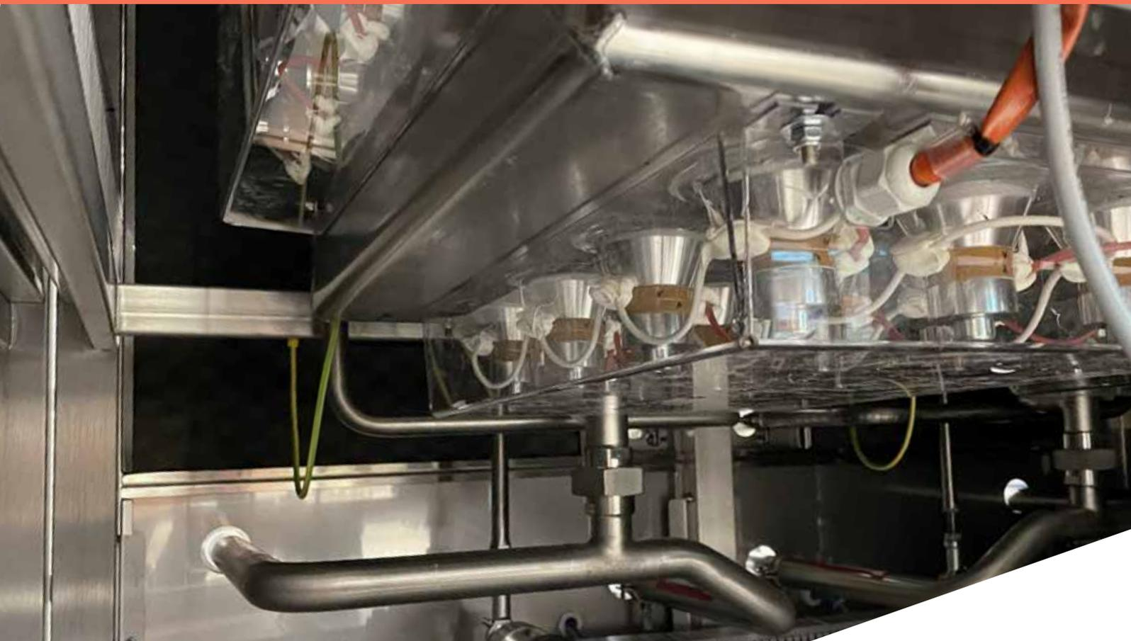
Photo détaillée des transducteurs ultrasons
