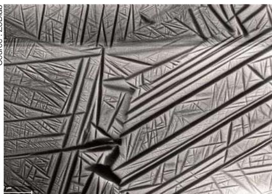
Image microscopique (MEB) illustrant la microstructure d'une pièce imprimée en ZTMN14.
