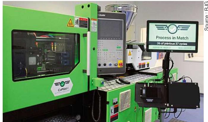
Système CoPilot installé sur un équipement de moulage par injection.
