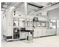
Sur les équipements X-tra line, le transport des pièces est entièrement automatisé, avec des zones tampons de chargement et de déchargement. Le remplissage initial et le rechargement en produit de nettoyage des cuves sont eux aussi automatiques. Les bains sont dotés pour cela d'un dispositif de surveillance.
