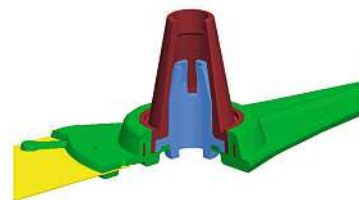
Exemple de sous-ensemble de 4 pièces assemblées et soudées à chaque cycle presse
