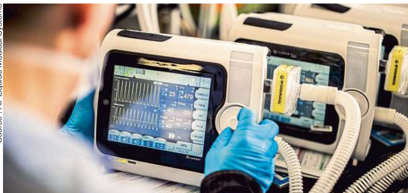
On distingue, au sommet des respirateurs, le cache noir du port USB développé par Nextis en Thermolast.
