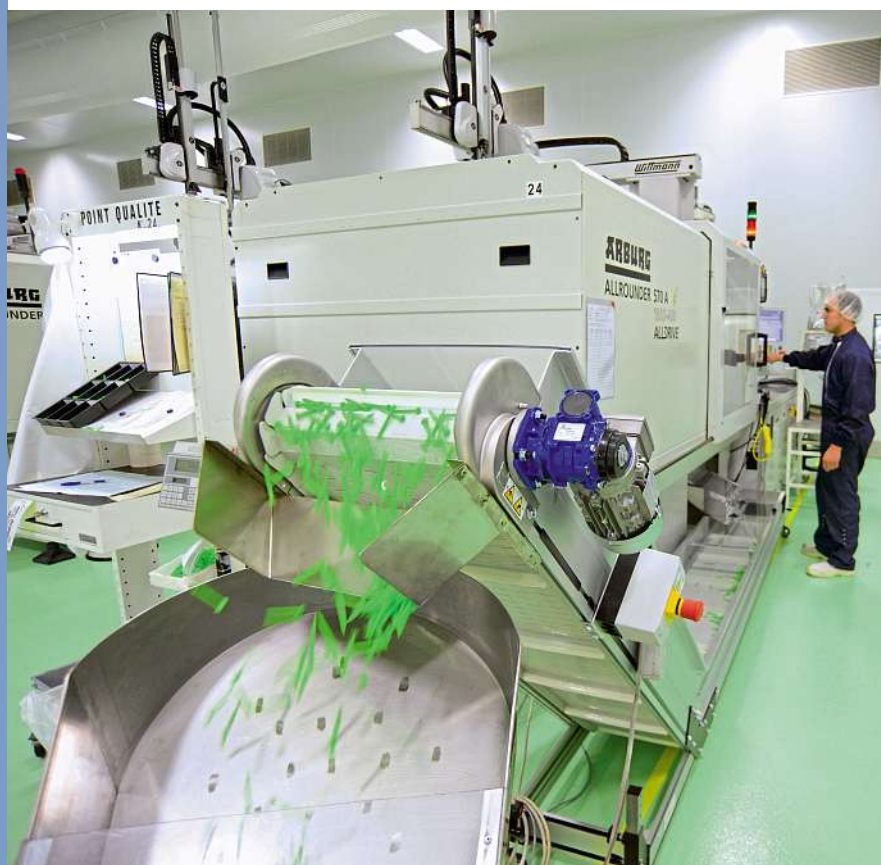
Production de pièces plastiques en salle propre ISO 8 sur le site de Rovipharm.
