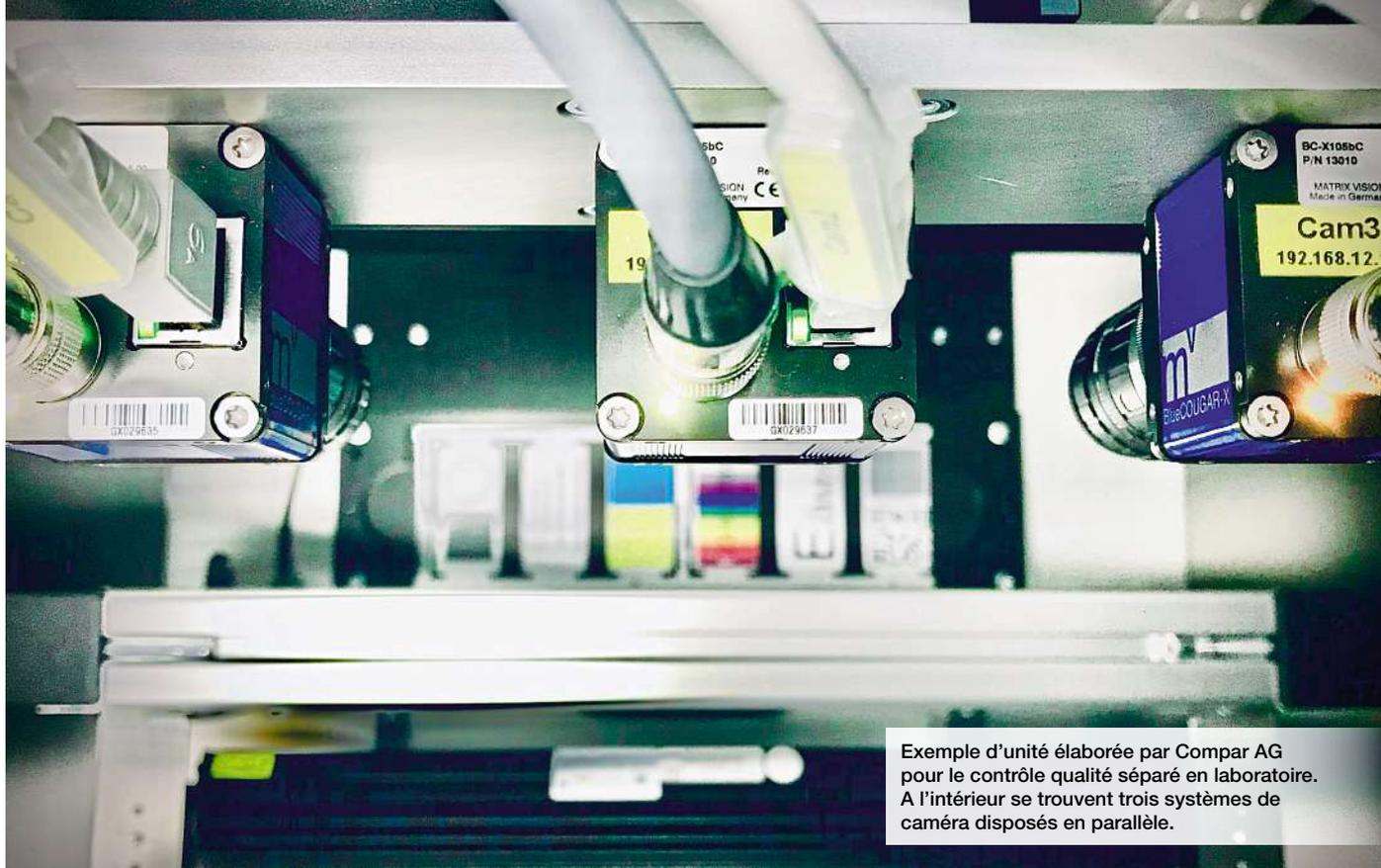
Exemple d'unité élaborée par Compar AG pour le contrôle qualité séparé en laboratoire. A l'intérieur se trouvent trois systèmes de caméra disposés en parallèle.
