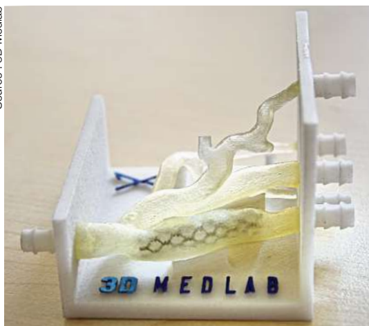
Stent Nitinol dans modèle anatomique imprimé 3D.
