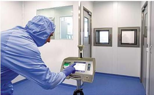
Compteur de particules pour mesurer le taux d'empoussièrement d'une salle propre en vertu de la norme ISO 14644.
