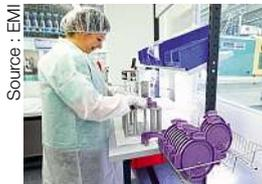
Assemblage, contrôle d'étanchéité et ensachage en salle blanche ISO 8.
