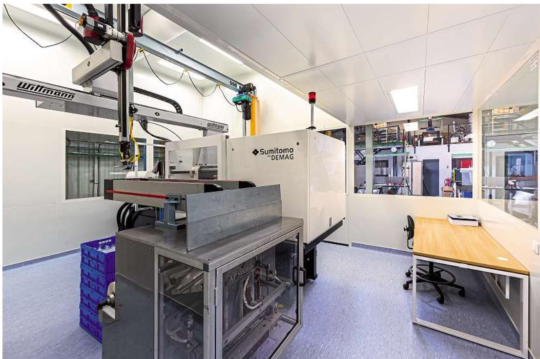
La salle blanche d'AXindus est équipée d'une presse 100% électrique Sumitomo Demag, d'un robot 3 axes numérique et d'une ensacheuse automatisée.
