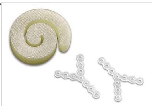
Samaplast teste le Freeformer sur différents implants comme cette spirale bi-matière en Bionate 65D et 80A destinée à stabiliser une zone de la colonne vertébrale ou encore cette plaque en Y en Resomer LR704 S destinée à la chirurgie faciale.
