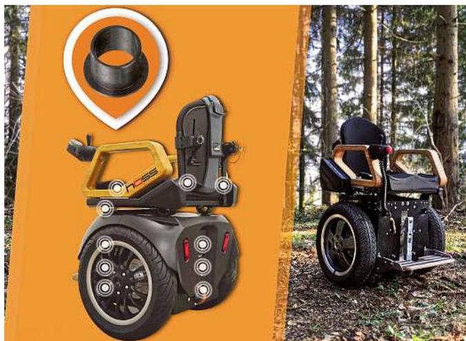
Les paliers lisses d'Igus participent à la sécurité de ce fauteuil roulant innovant basé sur le principe du gyropode.
