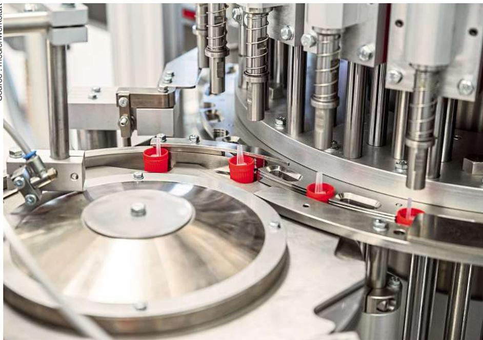
Une fois assemblés, les bouchons avec inserts compte-gouttes sont soumis à un contrôle de hauteur avant d'être triés pour éliminer les pièces non conformes.
