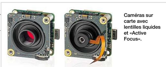
**Longévité** - Les caméras sur carte USB 3.1 Gen 1 de la gamme uEye LE sont proposées par IDS pour l'utilisation et la commande d'objectifs à lentilles liquides. Ces caméras font le point en quelques millisecondes sur des objets si-
