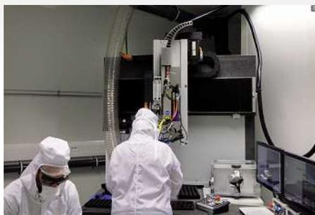
Aménagé dans sa salle blanche ISO 7, cet équipement présente en plus une enceinte de dimensions 350x250x200mm<sup>3</sup> entièrement automatisée, permettant la fermeture laser de pièces sous atmosphère contrôlée sous He, Ar, N<sub>2</sub> ou sous vide primaire.
