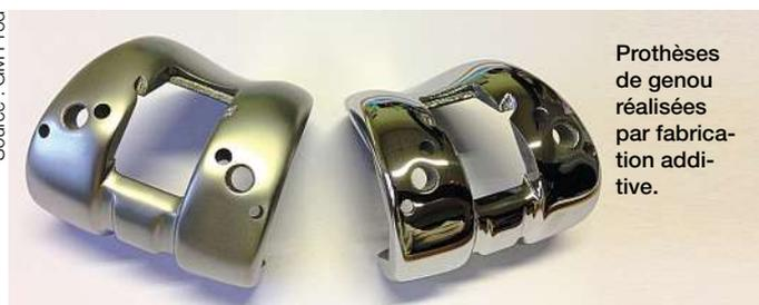
Prothèses de genou réalisées par fabrication additive.
