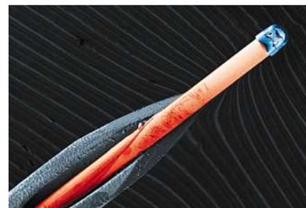
Lentille triplet à haute résolution imprimée directement sur une fibre, par exemple pour un endoscope.
