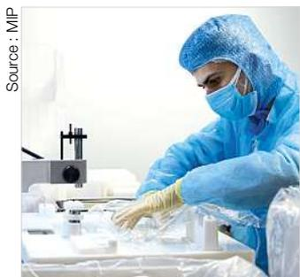
MIP Medical vient aussi d'acquiescer une nouvelle salle blanche classée ISO 7 destinée à l'assemblage de DM.
