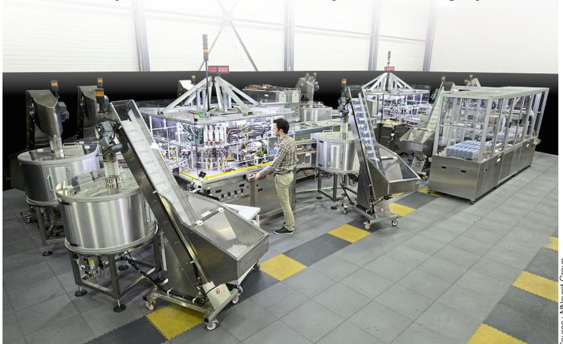
Cette machine conçue par Neyret Group permet d'assembler et de contrôler à 100% les 11 composants du stylo à insuline, à raison de 4800 pièces produites par heure.
