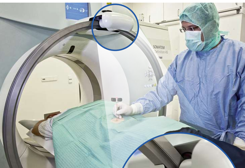
Le système de navigation au laser entièrement automatique de la société Amedo comprend un élément en arc de cercle monté au plafond.
