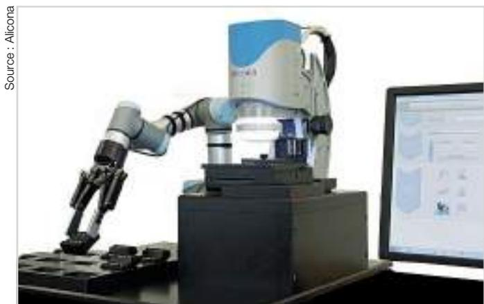
Le 'Pick and Place' peut être notamment utilisé pour mesurer les petits rayons et l'état de surface des pièces.
