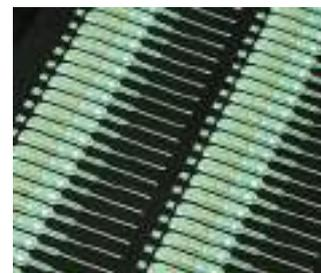
Les électrodes situées sur la partie extérieure peuvent être structurées et segmentées.
