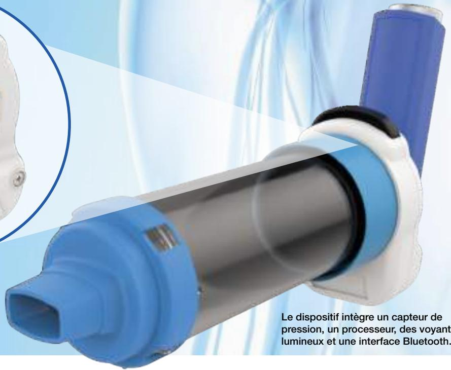
Le dispositif intègre un capteur de pression, un processeur, des voyants lumineux et une interface Bluetooth.
