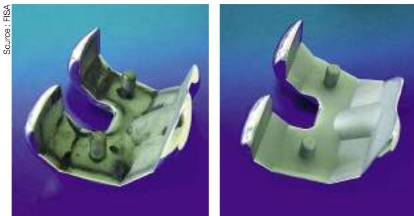
Exemple d'implant orthopédique avant et après nettoyage aux ultrasons.
