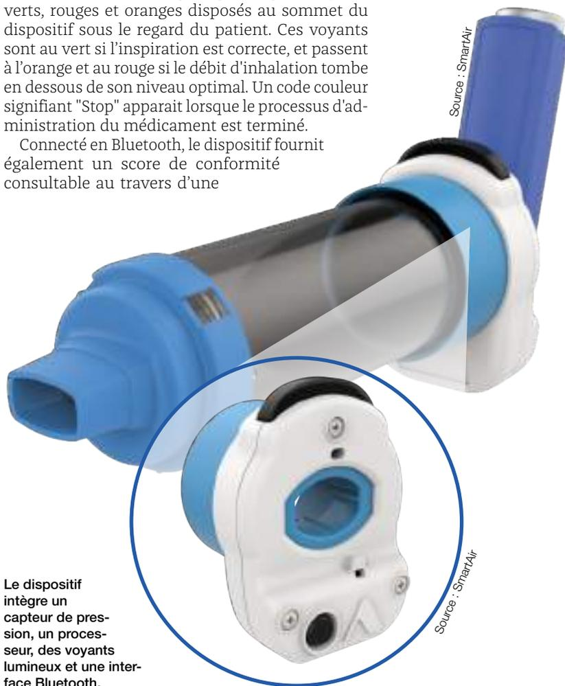
Le dispositif intègre un capteur de pression, un processeur, des voyants lumineux et une interface Bluetooth.
