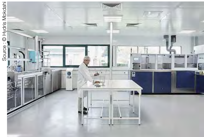
Fisa France vient d'intégrer deux lignes de nettoyage en salle propre ISO 8. Les essais pourront ainsi être réalisés dans des conditions d'empoussièrement, d'hygrométrie et de température maîtrisées.
