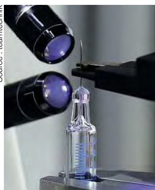
Dans cet assemblage, la colle est durcie par une technologie LED.
