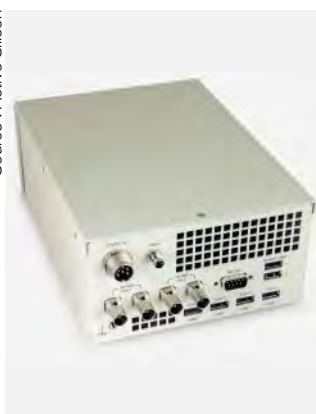
Un port offrant des interfaces clavier, souris, écran et réseau facilite le développement logiciel.
