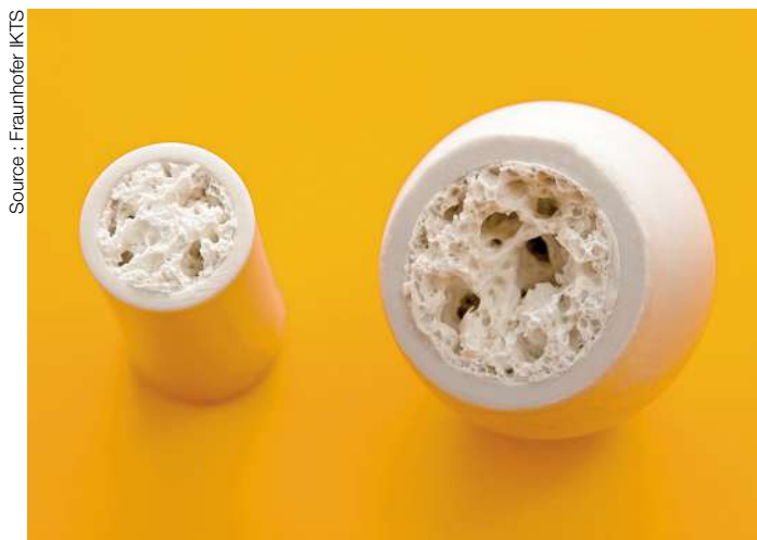
Céramique imprimée à l'extérieur et moussée à l'intérieur.
