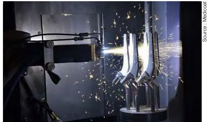
Des moyens de revêtement par projection thermique, développés pour Zimmer mais désormais accessibles à d'autres clients.
