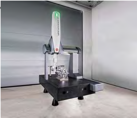
Machine MMT Leitz Reference après remise à niveau de ses fonctionnalités.
