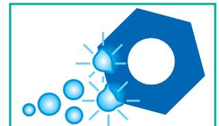
④ Lors des phases de pression, les bulles implosent au contact des surfaces immergées, en restituant leur énergie créatrice. De plus cette énergie mécanique accroît l'efficacité de l'action chimique de la solution de nettoyage à laquelle elle est associée.
