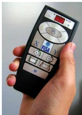
Le MCU (Machine Controller Unit) permet de modifier les paramètres de nettoyage, d'ajuster les séquences, de personnaliser l'affichage des données ou de générer des rapports de maintenance sans qu'il soit nécessaire d'entrer dans de la programmation.
