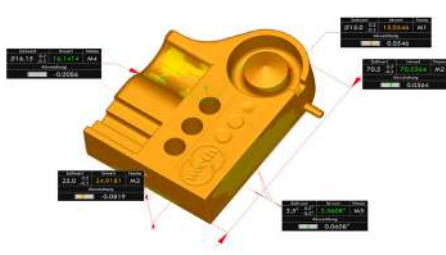
Evaluation dimensionnelle effectuée avec le support de la CAO
