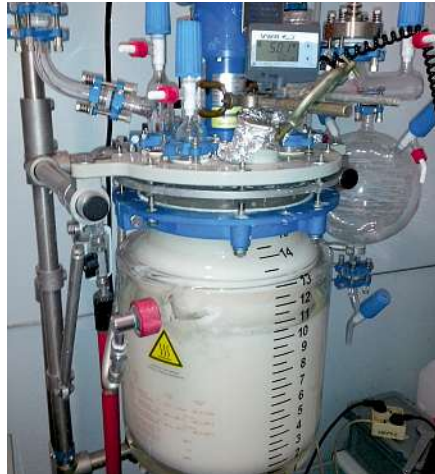
Illustr. 2 : Bioréacteur servant à la préparation de nanofibres de cellulose imprégnées de pénicilline
