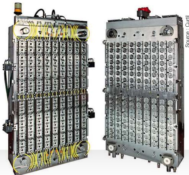
Moule 144 empreintes pour l'injection plastique de bouchons aseptiques.
