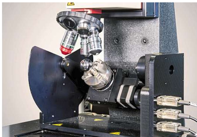
Modèle MarSurf CWM 100 constitué d'un microscope confocal et d'un interféromètre en lumière blanche.
