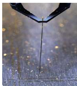
Insertion d'une broche de section carrée de 40 x 40 µm.
