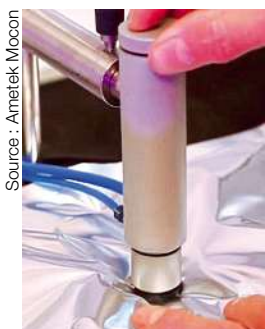
Le test d'intégrité requiert la mise sous pression de l'intérieur de l'emballage.
