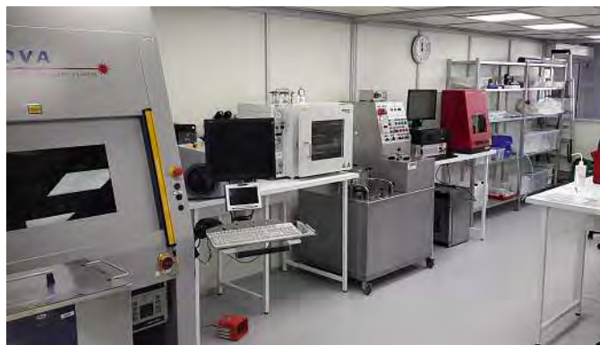
La salle blanche de Cisteo MEDICAL intègre la soudure laser, le marquage laser, le nettoyage et le conditionnement en ISO 5.
